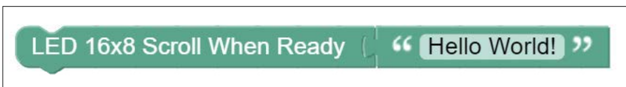
รูปที่ A3-1 โค้ดของไฟล์ OpenKB-Hello.txt สำหรับทดสอบการแสดงผลข้อความอย่างง่าย
