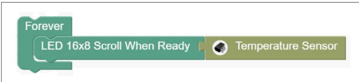
รูปที่ A3-5 โค้ดของไฟล์ OpenKB-TempRead.txt สำหรับทดสอบการอ่านค่าจากตัวตรวจจับอุณหภูมิบนบอร์ด OpenKB อย่างง่าย
